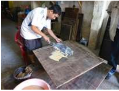
補強のため、パネルに漆で布を貼る
