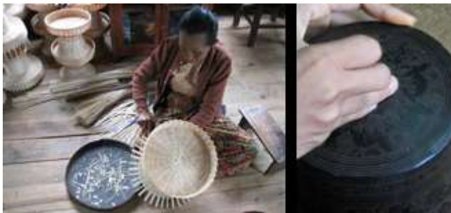
讃岐漆芸の源流ともいえる、東南アジアの籃胎漆器の胎作りと蒟醬の作業
