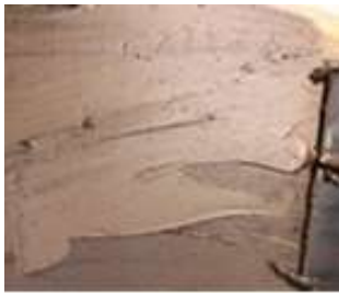
左：作ったばかりの錆下地 右：時間が経つと黒くなってくる
