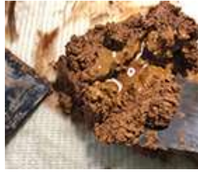
①砥の粉と水を練り合わせる ②①に生漆を少しずつ加える ③作ったばかりの錆下地
