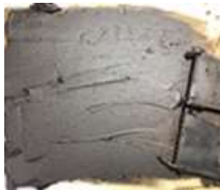
左：作ったばかりの錆下地 右：時間が経つと黒くなってくる
