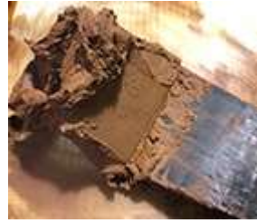
①砥の粉と水を練り合わせる ②①に生漆を少しずつ加える ③作ったばかりの錆下地
