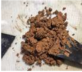
①砥の粉と水を練り合わせる ②①に生漆を少しずつ加える ③作ったばかりの錆下地
