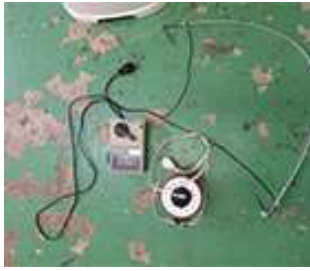
変圧器に接続したニクロム線
