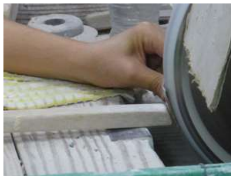
娘さんによる回転砥石に薄貝を棒で押し付けて平らな面をつくる作業
