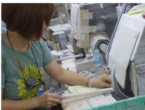
娘さんによる回転砥石に薄貝を棒で押し付けて平らな面をつくる作業
