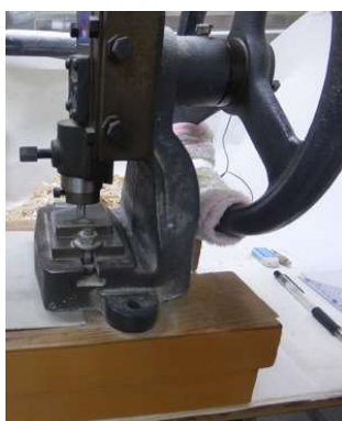
打ち抜き用の機械
