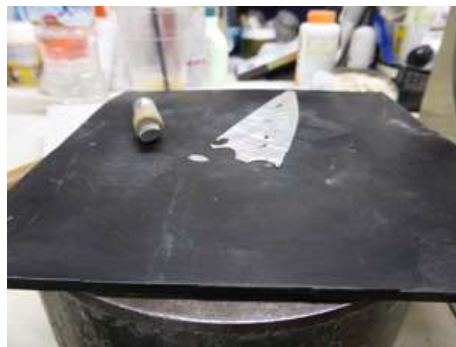
薄貝の花びら型の打ち抜き
